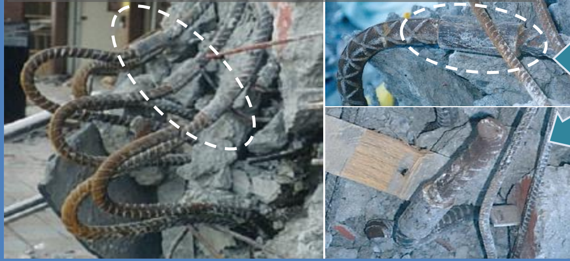
2016台南0206地震時的鋼筋續接器 - 嚴重鬆脫
