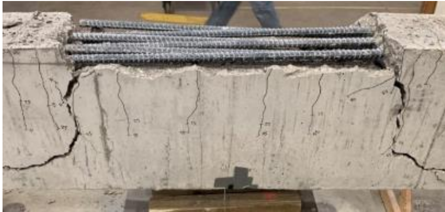
無圍束混凝土梁試驗
