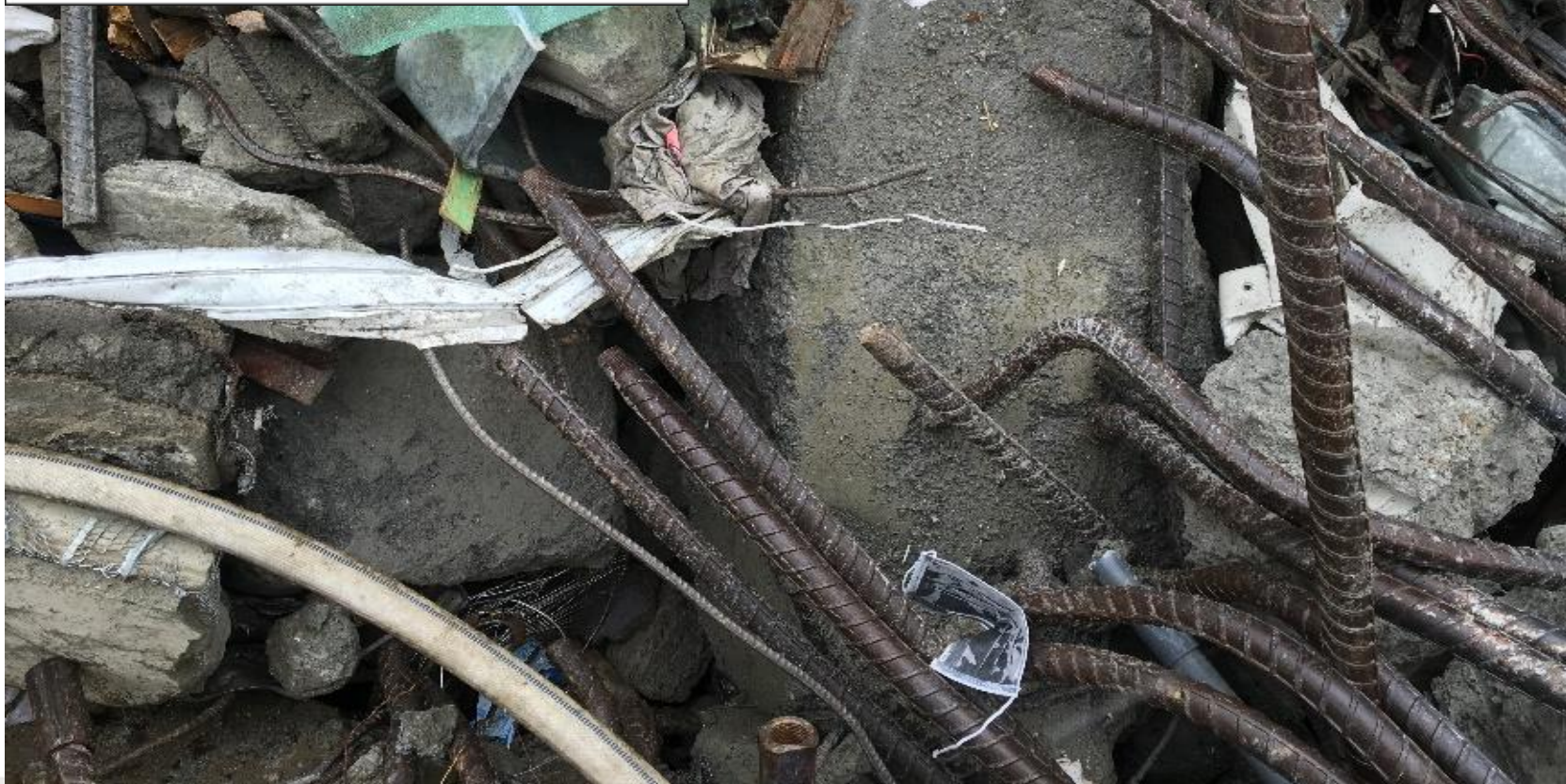
台南維冠金龍大樓倒塌現場清理之鋼筋續接接頭照片(蘇模原技師提供)
