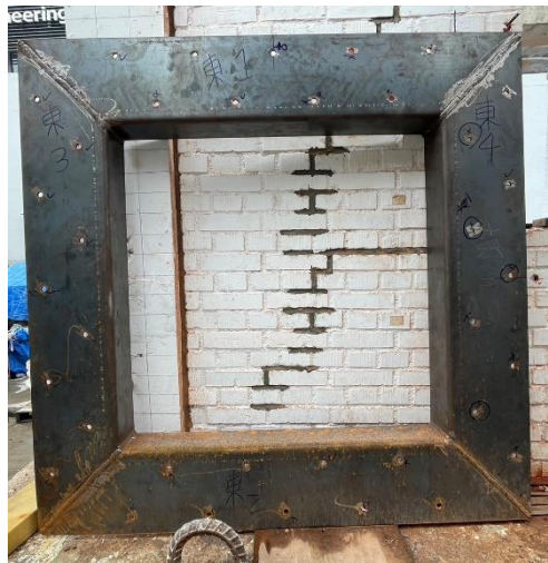
1. 鋼框補強構件
