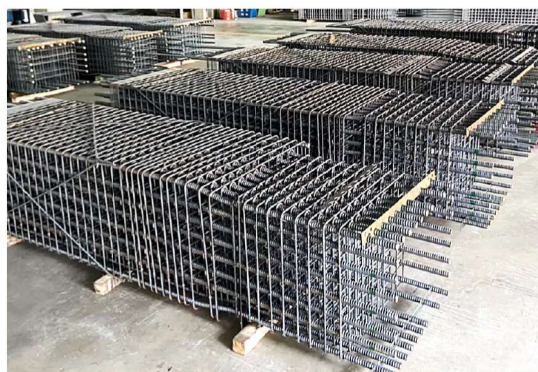
鋼筋工程廠製化
