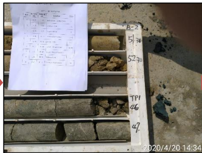
5. 判岩及岩盤深度確認(壁樁)
