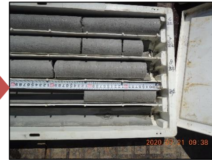
8.樁體鑽心取樣確認樁長
