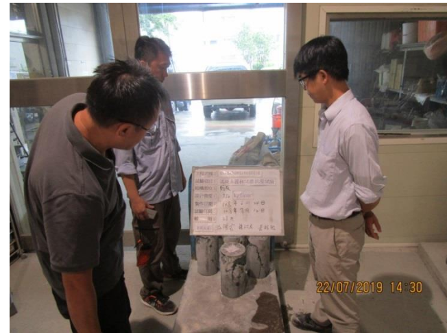
◎ Step.11 混凝土試體抗壓試驗(28天)
