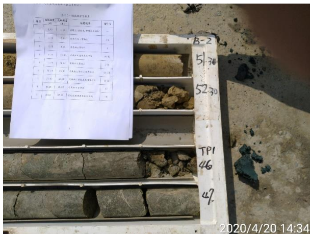
◎ Step.5 判岩及岩盤深度確認(壁樁)
