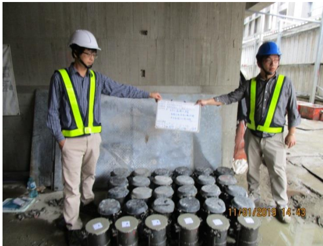
△ Step.7 圓柱抗壓試體製作
