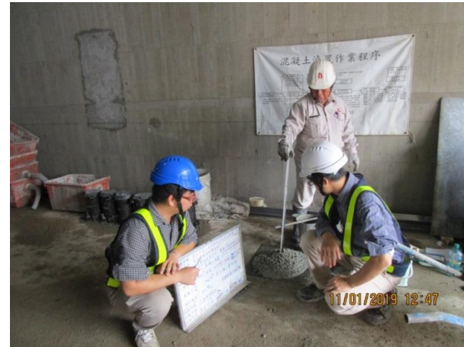
△ Step.6 坍度、溫度及氯離子試驗
