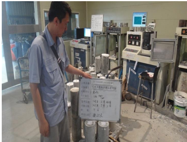
◎ Step.10 混凝土試體抗壓試驗(7天)
