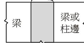
(b) 梁邊緣平齊處之銲道端部處理原則
