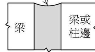
(c) 梁邊緣平齊處銲道端部之凸度與凹度要求
