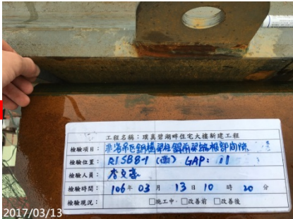
銲前梁柱銲道間隙 抽測
