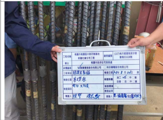
鋼筋續接器 D32(#10)取樣送樣 14 支
