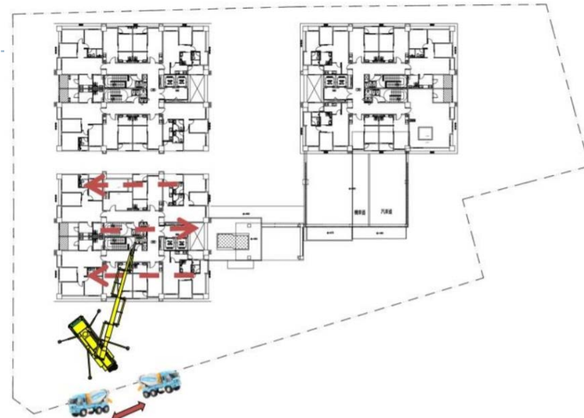
9FL 混凝土澆置圖
