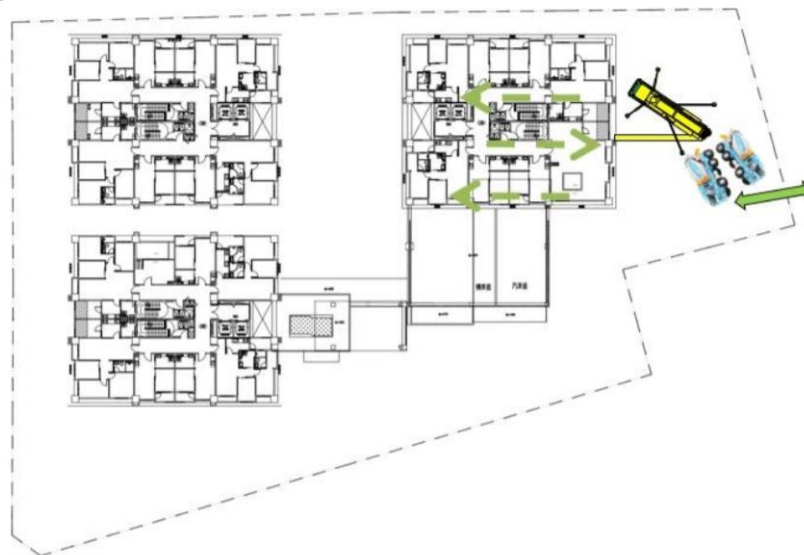
9FL 混凝土澆置圖
